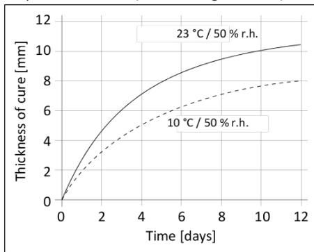
Diagramma 1: Velocità di indurimento per Sikaflex®-515
